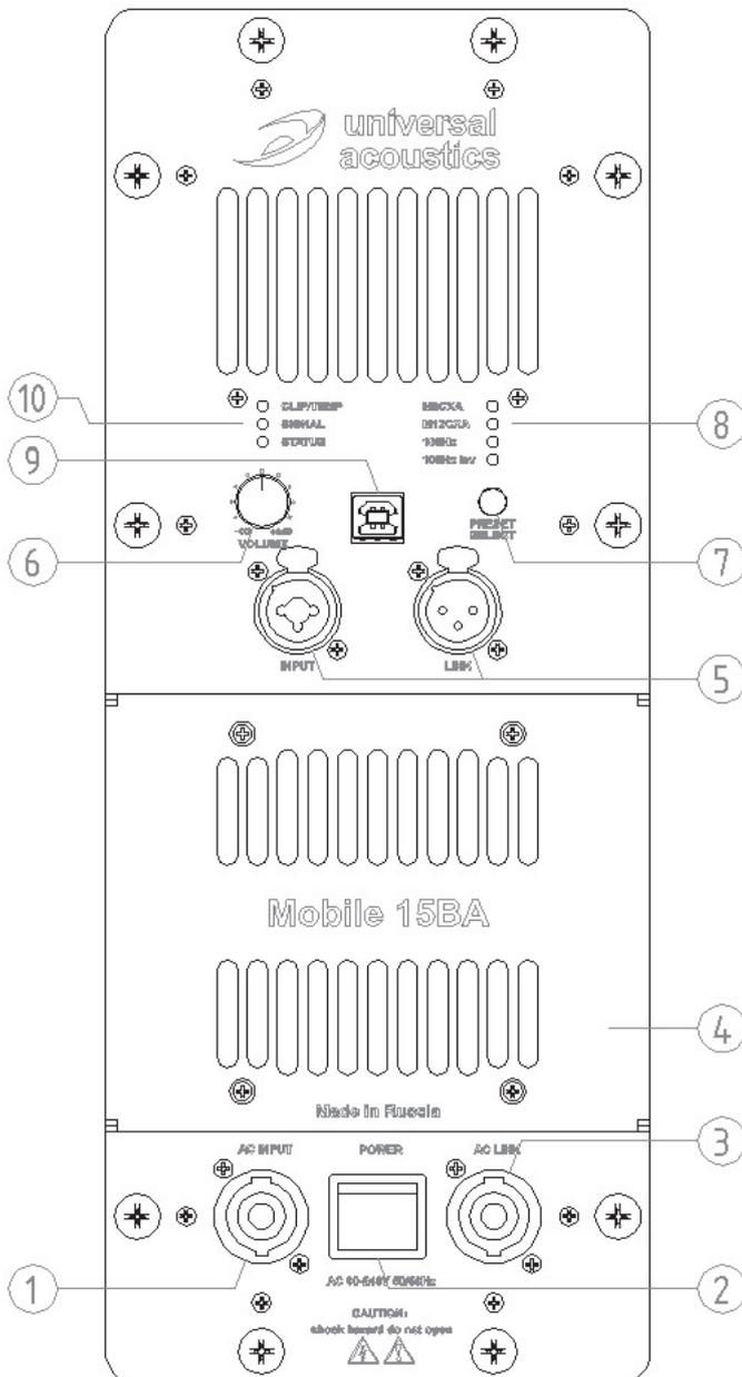
Поз.1 - **AC INPUT** – разъем для подключения сетевого кабеля ~220/230В, 50/60Гц.
